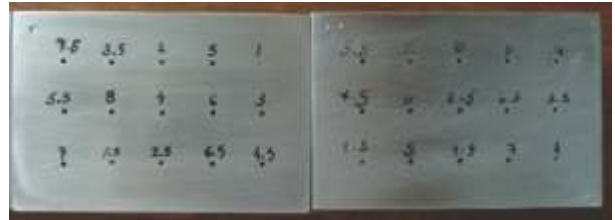
Figura 6. Vista frontal de los 2 bloques que se usaron en el procedimiento orificios con profundidades desde 1-8mm reales.
