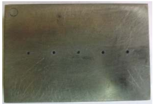
Figura 7. Vista frontal del bloque de prueba de aluminio con las dimensiones de cada bloque (6cm de largo por 4cm de ancho).
